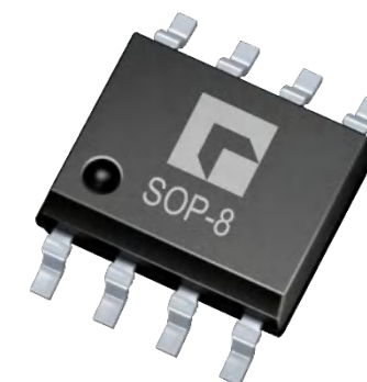
型号: BTP1521P 封装: SOP-8
