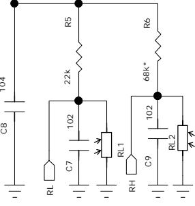
光线越暗、电阻越大、分压越大、ADC值变大
