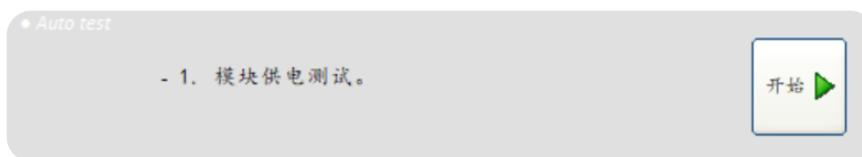
A：当在“-1. 模块供电测试”的左边如果显示的是“OK(√)”，则进一步观察示波器上的这段电压波形是否稳定在“+7.5 ~ 15V”范围内。
