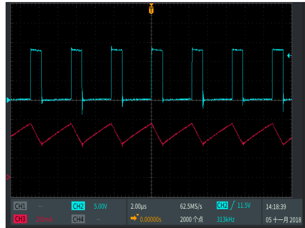
SW脚与电感电流工作波形
