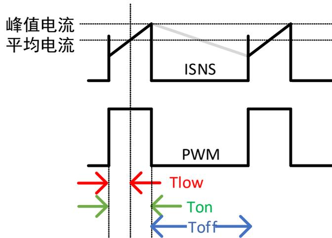
当 Dim% 处于 12.5% 到 0.39% 之间时，IC 工作在 Burst 模式下。每簇 burst 以 128 个 DRV (CCM) 周期为组，当 Dim% 下降后，burst 的占空比下降。例如处于 Dim%=6.5% 时，IC 将工作 64 个 DRV 周期，停止 64 个 DRV 周期。此时 64 个工作周期内，电感平均电流和峰值电流都和 Dim%=12.5% 时 (CCM 模式最底端) 保持一致。
