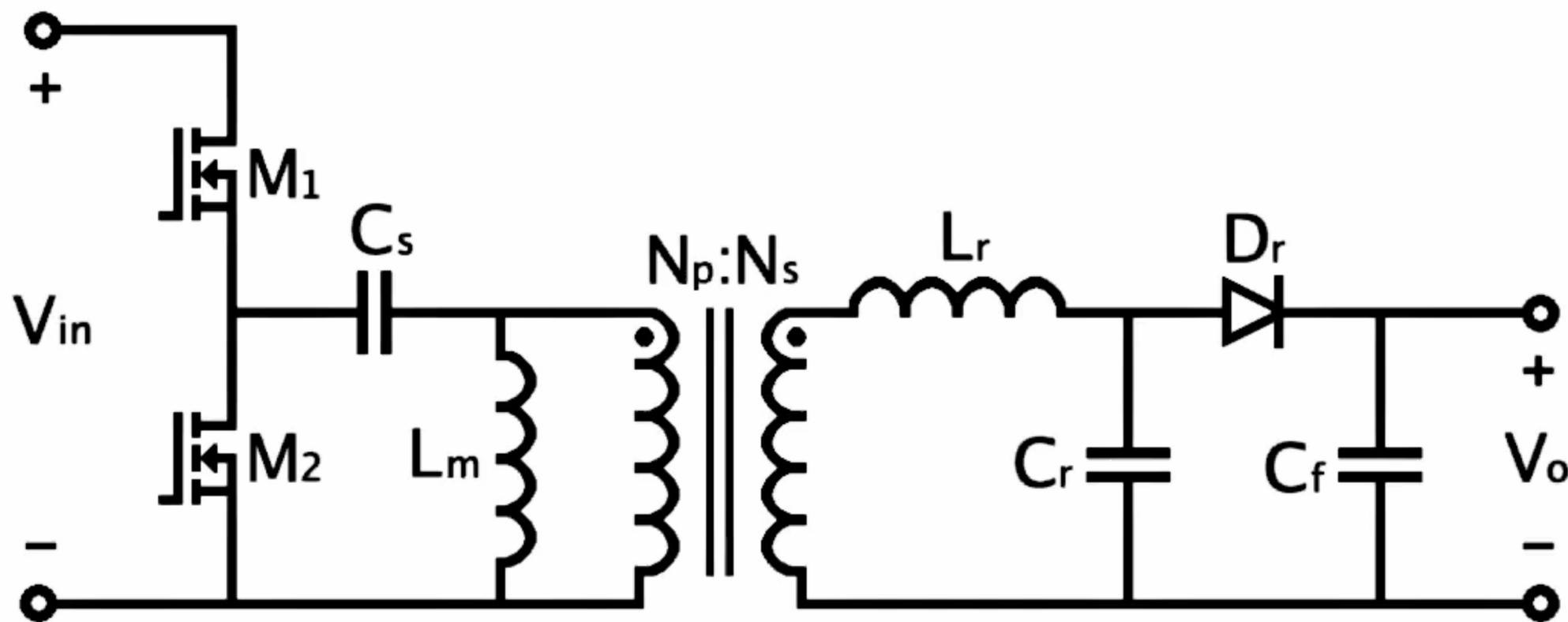
在输入端子两端，两个MOSFET以半桥配置连接；DC隔直流电容器连接到半桥逆变器的输出端；包含磁化电感的变压器通过其初级绕组耦合到DC隔直流电容器；谐振电感器连接到次级绕组，并且可以与变压器集成；谐振电容器放置在次级绕组和谐振电感器之间；二极管或同步整流器连接在谐振电感器和谐振电容器之间；以及滤波电容器放置在输出端子两端。
