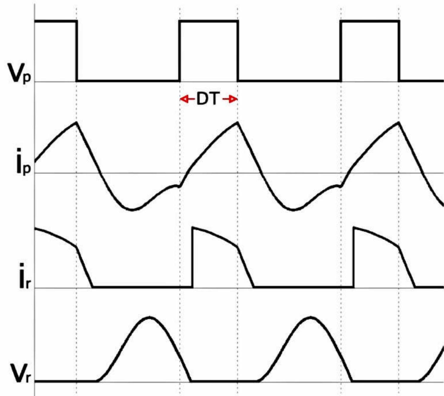
输出电压或输出电流的调节可以通过固定脉冲波电压的频率和改变占空度 $D$ 来实现。从而导致如果所述占空度减小则输出功率减小并且如果所述占空度增加则所述输出功率增加。
