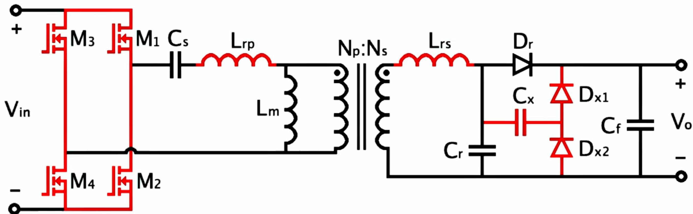
Pe17电路的替代结构可以包括全桥逆变器或倍压电路。
