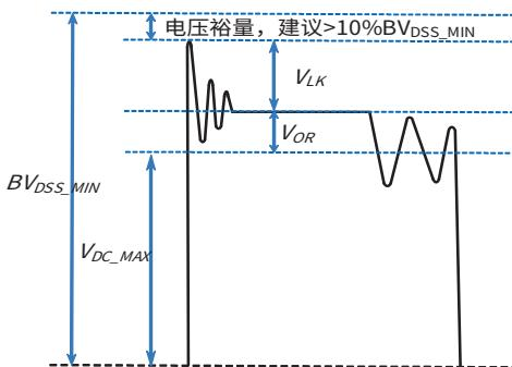
图12. MOSFET漏极电压波形
