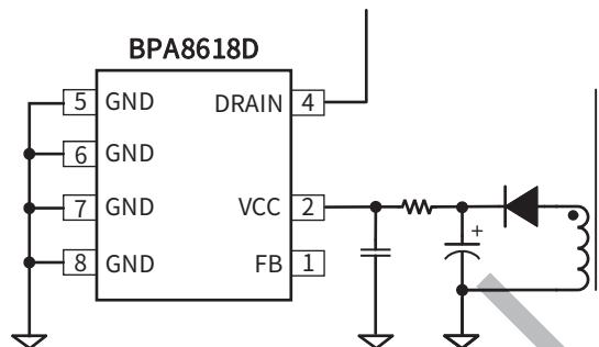
图14. 辅助绕组供电电路
