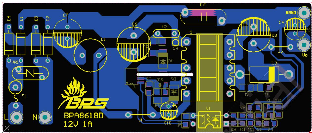
图 18. BPA8618D 设计实例 PCB Layout (单面板)
