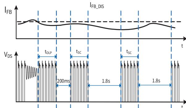
图 9. 故障保护与自动重启时序
