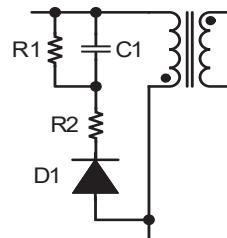
图15. RCD钳位电路
