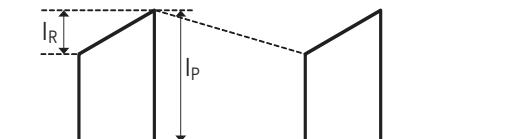
图13. 连续模式下初级电流波形
