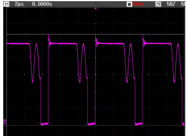
Vin=264Vac, Vout=20V, Iout=3.25A Vds_pri (max) = 537V
