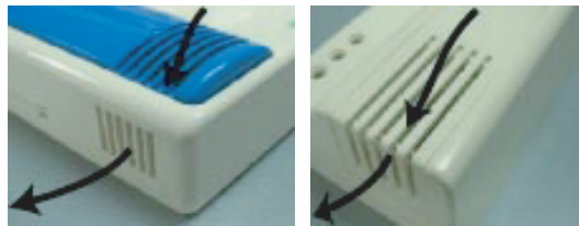
图4 传感器隔室壳体设计示例
