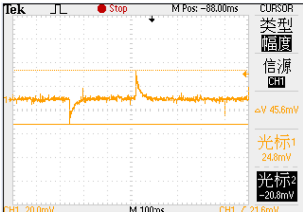
5. 纹波抑制 (IL=50mA, Vpp=1V, F=1KHZ)
