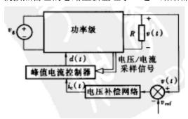
上图就是一个经典的峰值电流型控制的变换器的拓扑。所谓的峰值电流型控制的功率级传递函数是指上图中的峰值电流控制器的传递函数与功率级的传递函数的乘积。如下图:
