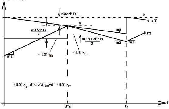
其中,在 m1 阶段,即电感电流上升阶段, <iL(t)>dTs 阶段的平均值为
