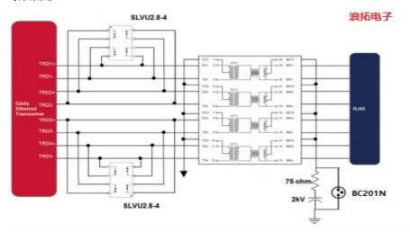
RJ45 接头的以太网信号电缆是平衡双绞线,感应的雷电过电压以共模为主,如果能够对过电压进行有效的防护,差模的防护选用小量级的器件就可以了,通常可以选用 SLVU2.8-4,它可以达到差模 0.5kV(1.2/50us)的防护能力。
