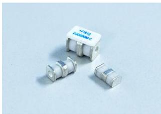
**TSS 晶闸管：**一种与 MOV 和 TVS 不同的固体放电管，由于采用半导体工艺，响应速度更快，寿命比 GDT 长，主要用于信号回路的防雷保护，可在纳秒级时间内将电压箝位于比击穿电压更低的 0V 的水平上。
