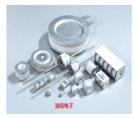
浪拓电子电路保护 GDT (气体放电管) 并联在电源线、电信线、信号线和数据传输线等敏感通讯设备的前端 , 进而保护它们免受因闪电和设备开关操作引起的瞬间浪涌 电压的破坏。正常情况下,这些器件并不会影响信号的正常工作。在过压情况下,GDT 可转换到低阻状态,使能量离开敏感的设备。
