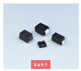
浪拓电子电路保护 TSS (半导体放电管) 系列浪涌抑制器增加了新的产品。这些新的双向半导体放电管扩大了电压提供范围并降低了电容值,可用于保护高速 ADSL / VDSL 调制解调器、以太网和以太网供电电路和其他高速通信设备,防止它们因为过电压而受到损坏。
