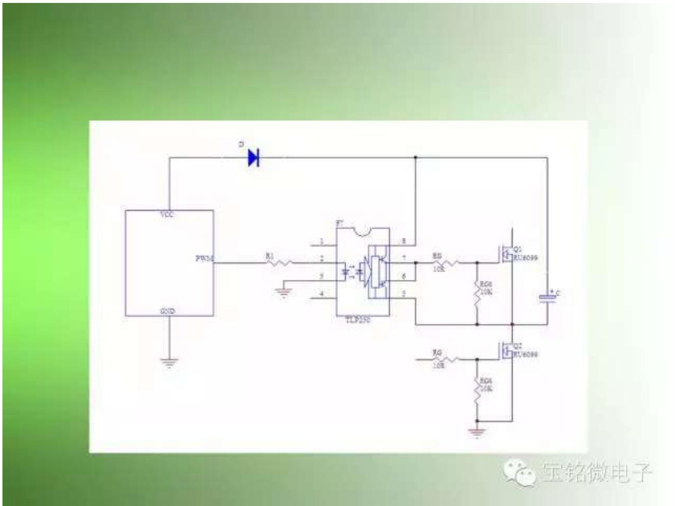
由图中可以看出，当Q2导通时自举电容C的负端接近地电位，PWM供电电源通过自举二极管向自举电容充电，自举电容两端很快充到接近PWM供电电源电压；当Q2截止时，自举电容C的负端电位上升，因而TLP250的8脚电位跟着上升，所以通过自举TLP250的供电可以超过干线电压驱动高端的Q1。
