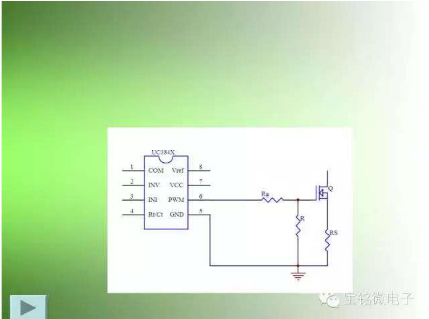
上图中可以看出MOS的源极电位在MOS 导通时比驱动电路的地参考点高RS上的压降，根据UC38xx的特点可知这个压降不超过1V.如果UC38xx6脚输出的电平可以达到12V, 那么MOS的GS极电压还有 $12-1=11V$ 显然还是足够的。
