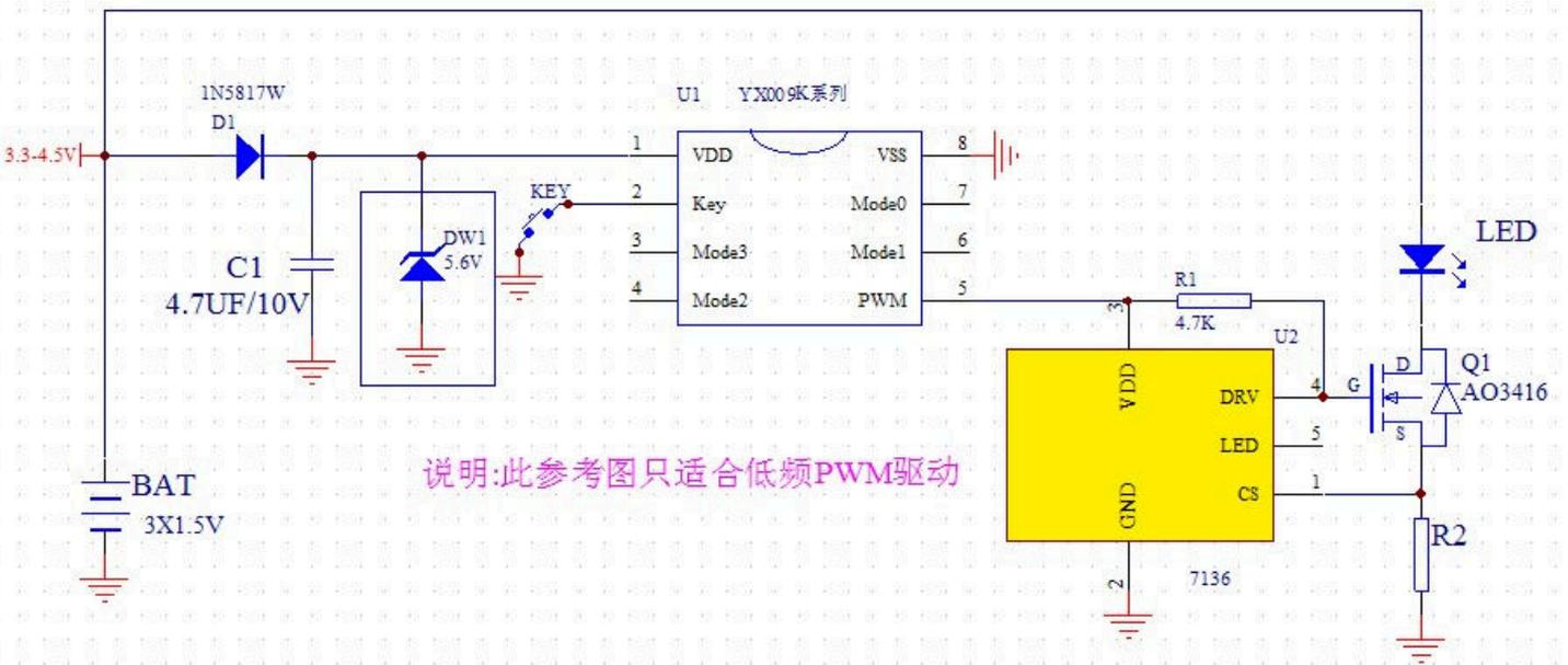
**\* 与带PWM调光端口的恒流IC组合使用参考线路：**
