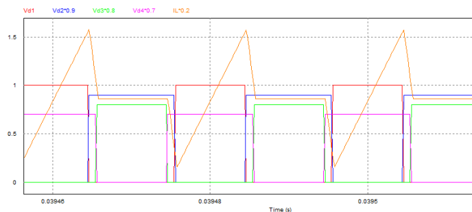
图 17 非同步脉冲控制下降压波形
