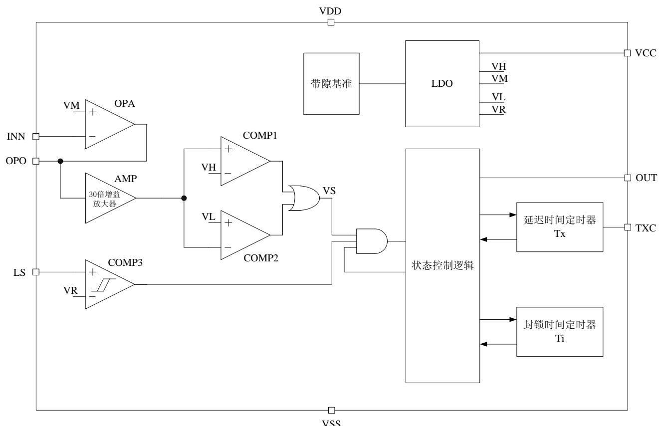
图 2: QXRS012 的内部电路方框图
