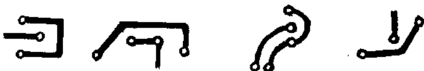
图 6.3.12 印制导线图例
