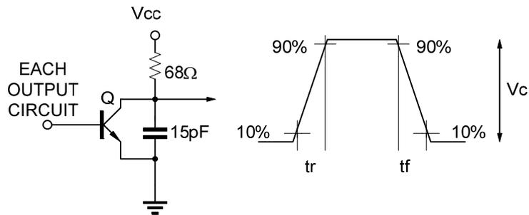
FIG. 3 COMMON-EMITTER CONFIGURATION
