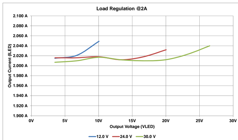
圖 7. 在不同輸入電壓下，輸出電流對 LED 串聯顆數圖
