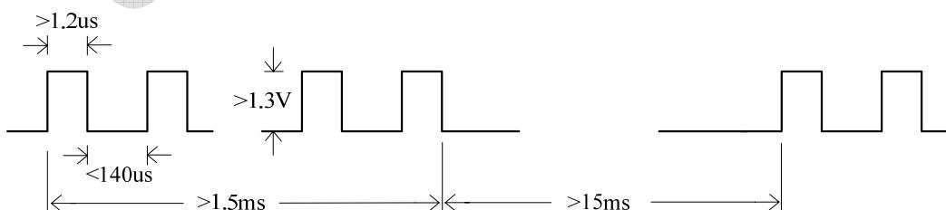
图 3 检测脚波形的要求示意图
