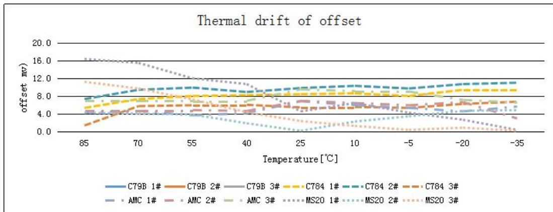
MS20 测试板最高温漂 11.9。AMC1200B 测试板最高温漂 4.0。ACPL-C784 测试板最高温漂 4.1。ACPL-C79B 测试板最高温漂 5.5。测试数据显示，AMC1200B 测试板温漂最低，ACPL-784 测试板温漂次之，ACPL-C79B 温漂第三，MS20 测试板温漂最高。
