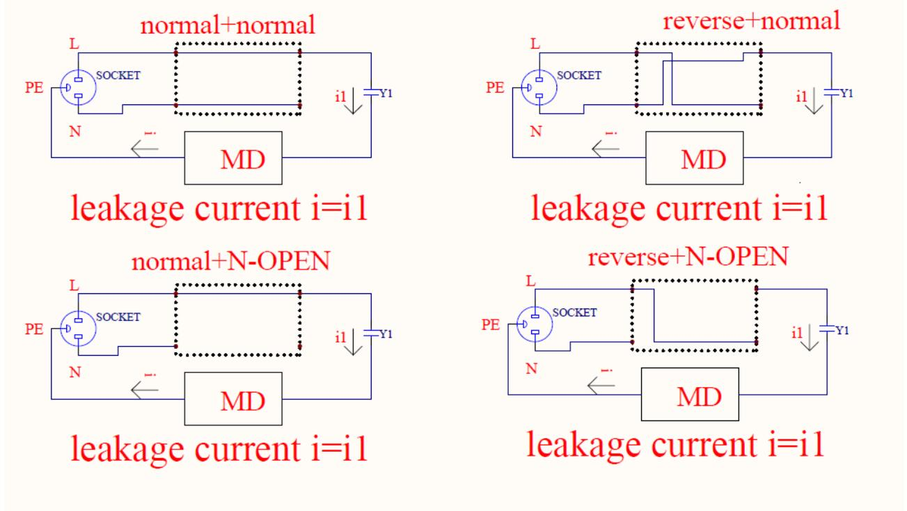
上图是四个输入电压的状态，流过模拟人体网络的电流与流过 Y1 的电流是一样的，我们计算流过 Y1 的电流是不是就是泄漏电流？
