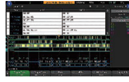
图 18: SPI 4 线解码和触发
