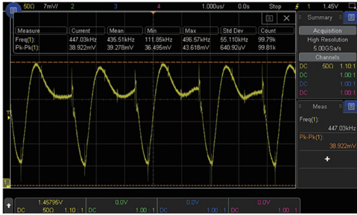
图 30: 3000T X系列和N7020A不仅能采集电源噪声及纹波，还会采集高频瞬变信号。
