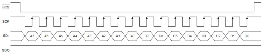
写类型格式：8-bit 命令输入+8-bit 数据输入
