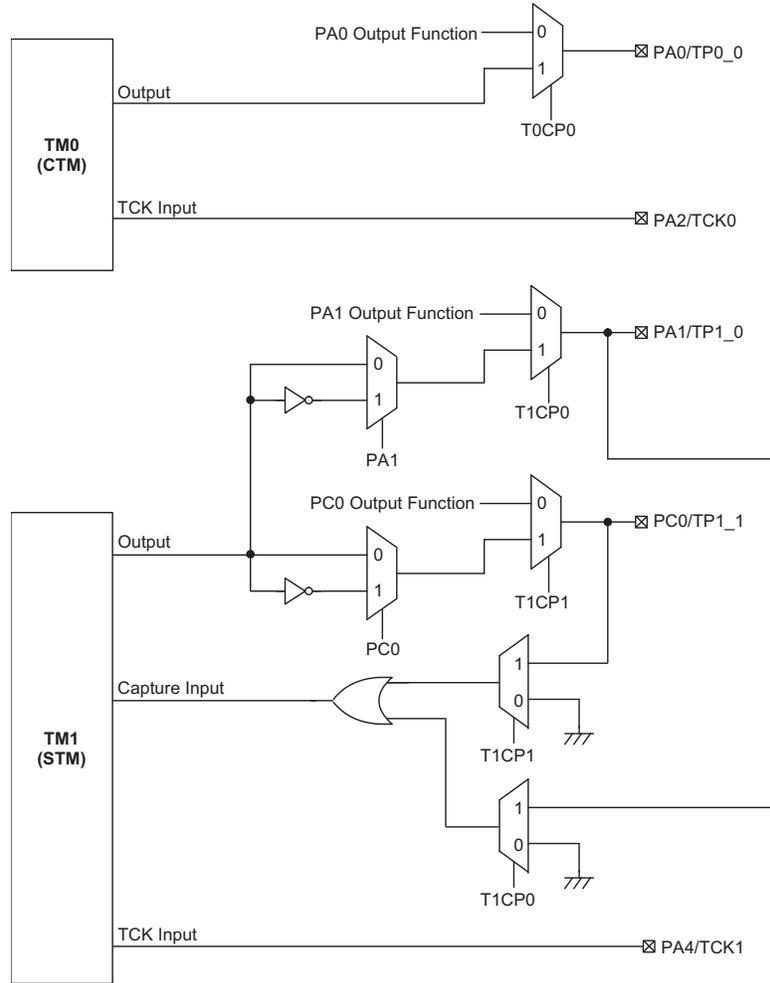
HT66F20 TM 功能引脚控制方框图
