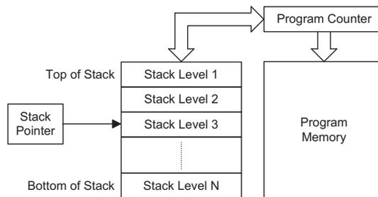
如果堆栈已满，且有非屏蔽的中断发生，中断请求标志会被置位，但中断响应将被禁止。当堆栈指针减少 (执行 RET 或 RETI)，中断将被响应。这个特性提供程序设计者简单的方法来预防堆栈溢出。然而即使堆栈已满，CALL 指令仍然可以被执行，而造成堆栈溢出。使用时应避免堆栈溢出的情况发生，因为这可能导致不可预期的程序分支指令执行错误。
