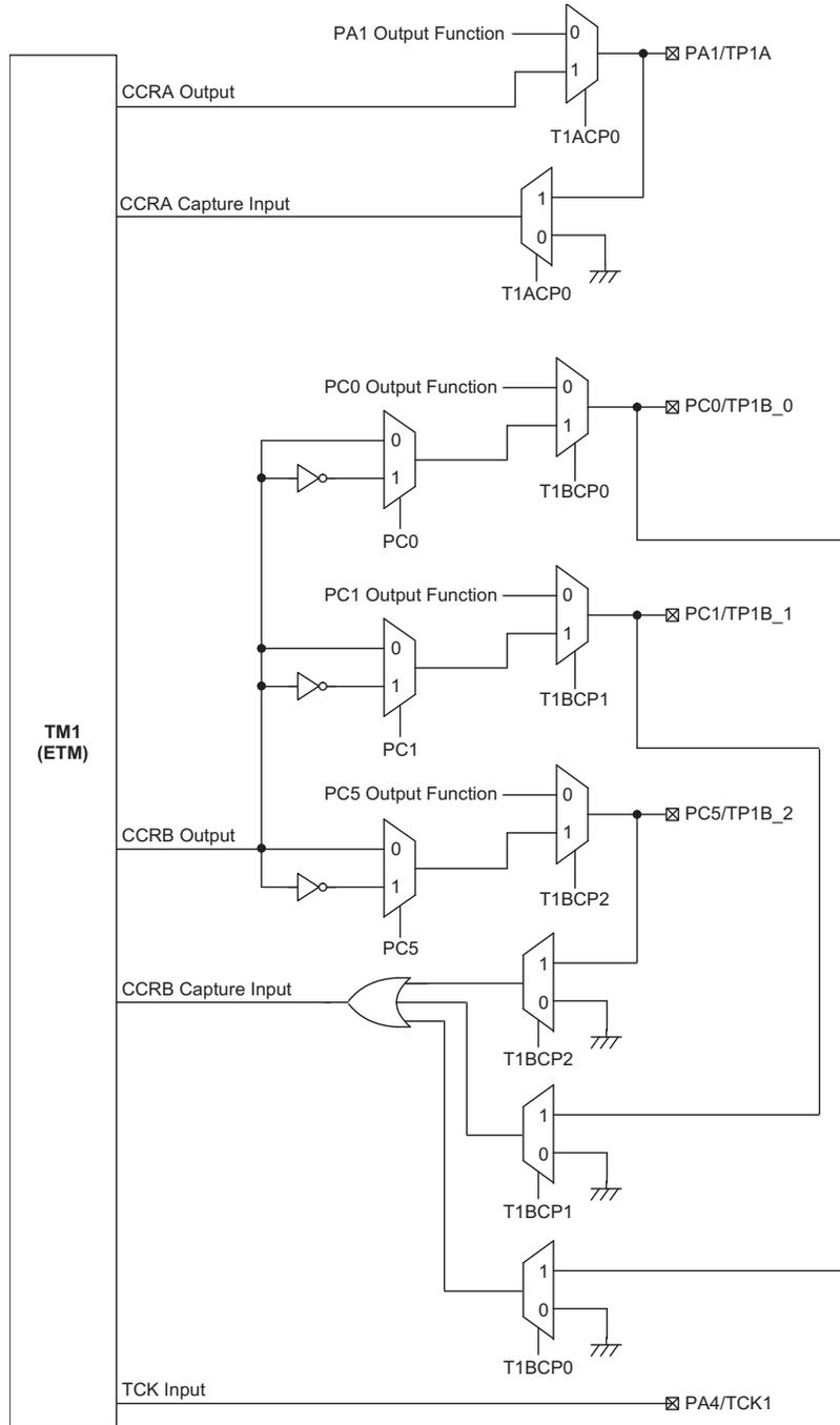
HT66F40 TM1 功能引脚控制方框图
