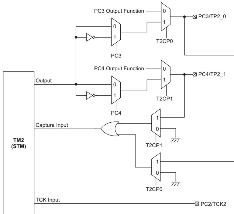
HT66F40 TM0&TM2 功能引脚控制方框图
