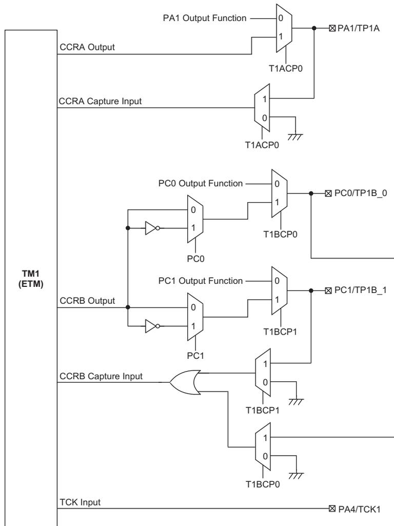
HT66F30 TM 功能引脚控制方框图
