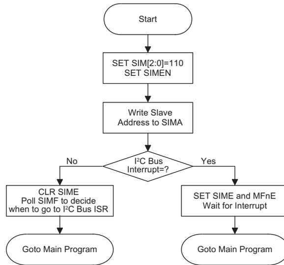
**I<sup>2</sup>C 总线初始化流程图**
