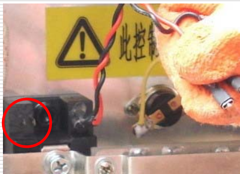
1 将驱动板上4组驱动线全部拔下拔插针时手应捏住插针。
