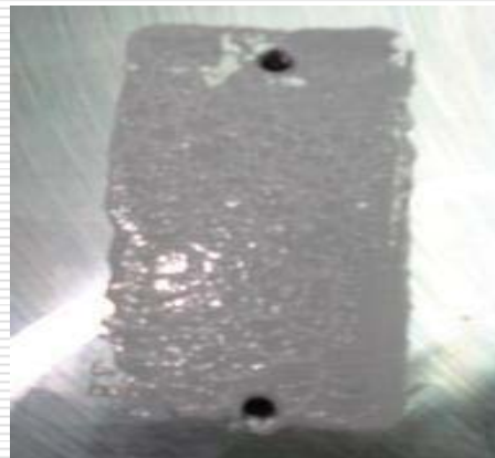
3 用干净的抹布清除散热器的导热硅脂
