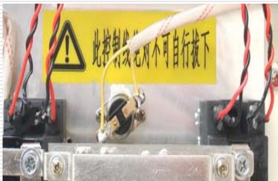
6 将驱动板上4组驱动线全部一一对应插牢，注意极性不要插反，不能松动。
