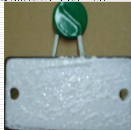
4 在新的整流桥散热板上均匀涂抹导热硅脂
