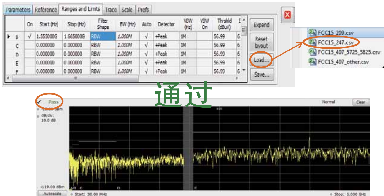
图 17: 杂散测试举例 FCC 15.247
