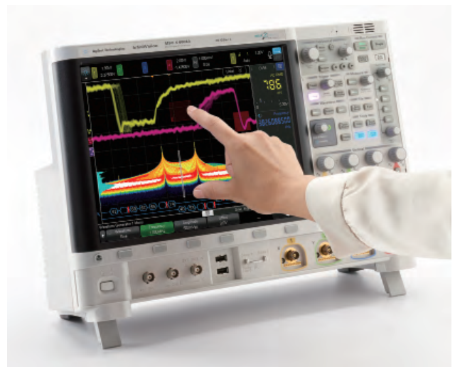
图 9. 多点触控操作。
