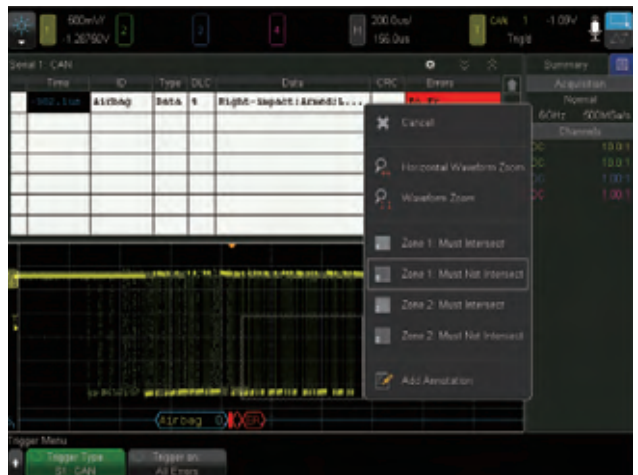
图 13. 触发条件设为 CAN 总线误差，再加上 InfiniiScan 画图触发。
