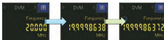
图 33. 精密 10 位计数器测得时钟的真正频率略低于 20 MHz
