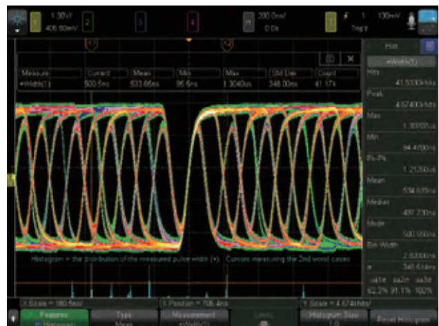
图 16b. 以直方图的形式显示脉冲宽度测量结果。
