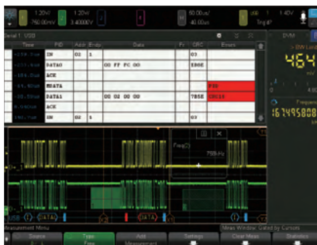
图 30. USB 2.0 协议触发与解码选项的结果显示。
