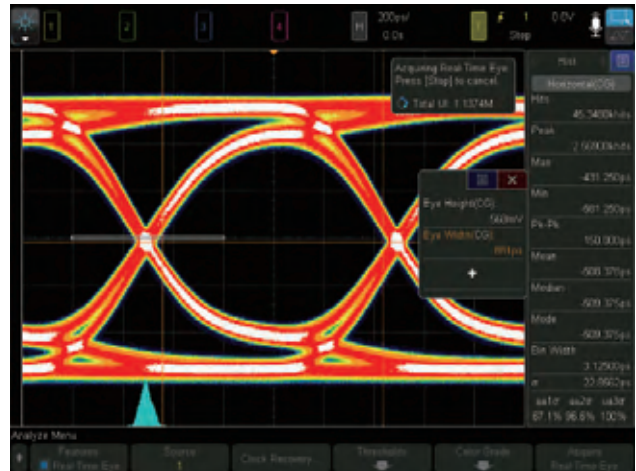
图20. 带嵌入式时钟的1Gbps PRBS的实时眼图测量。直方图显示抖动为22ps rms。
