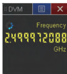
图 32. 10 位计数器精确测量 2.5 GHz 信号的频率
