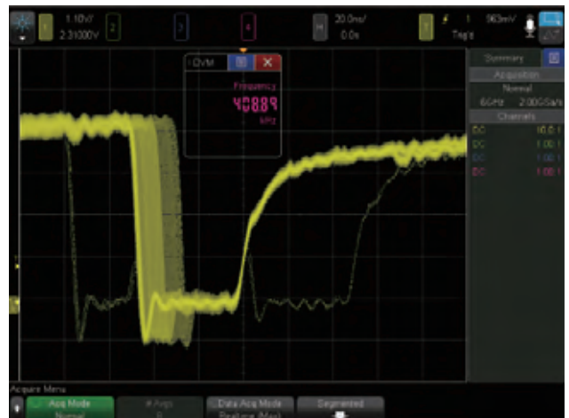
图 10. 6000 X 系列超高的波形捕获率可以帮助发现罕见毛刺。
