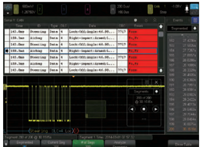
图 25. 分段存储器 + 串行总线解码 + InfiniiScan 区域触发。
