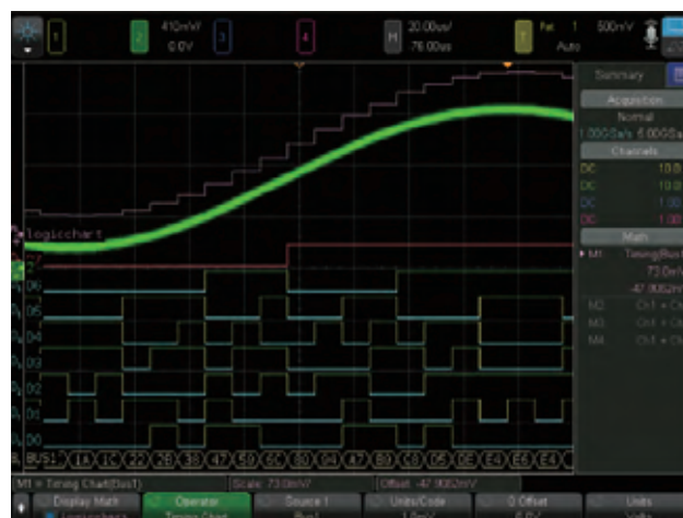
图26. 逻辑计时图功能与模拟信号和数字信号同时显示
