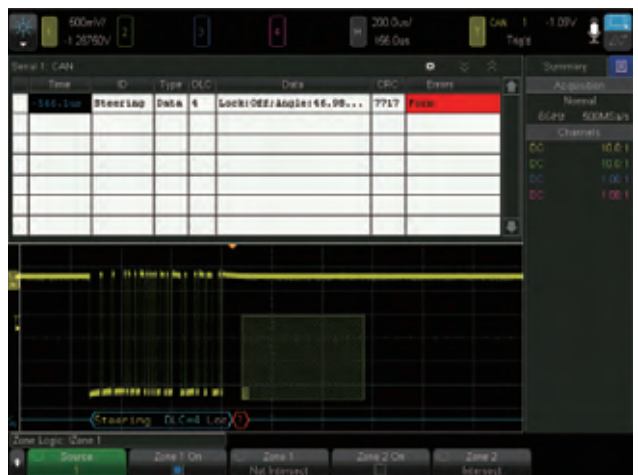
图 14. 现在成功地从 CAN 总线的各种错误中，隔离出与方向盘协议相关的错误。
