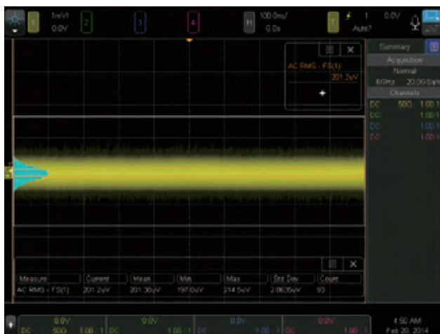
图6. 测量6GHz示波器在1mV/格时的本底噪声。
