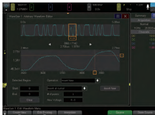
图28. 任意波形发生器的信号编辑界面。
