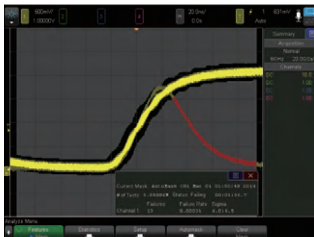
图40. 偶发毛刺极限测试
