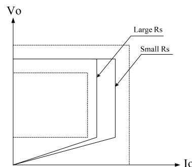
图 2 输出功率随  $R_S$  的变化曲线
