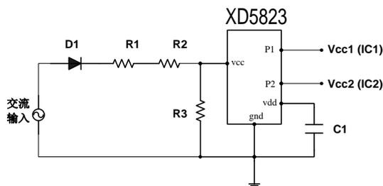
图3 XD5823的供电示意图
