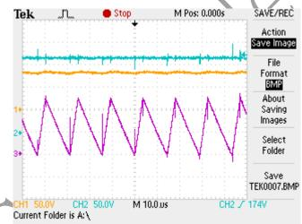
7.4 240Vac满载工作时,输出二极管反向电压波形
