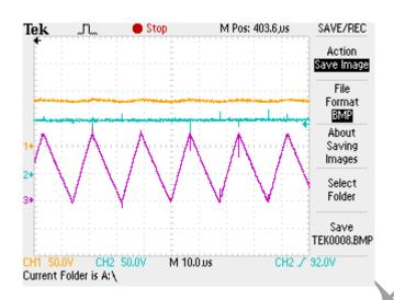
7.3 240Vac满载工作时,基本信号波形 其中1通道为Vo波形,2通道为整流过后的Vin波形,3通道为Io波形。
