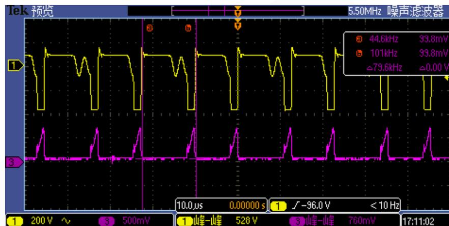
90V 60Hz AC 输出纹波 FULL LOAD
