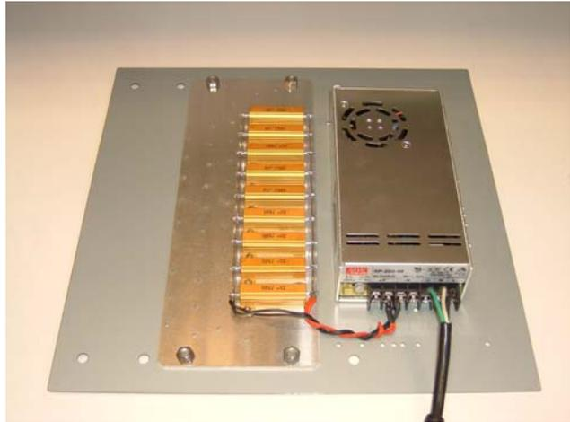
图 5.1 EMC 测试配置
