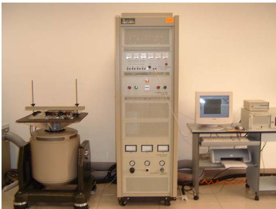
图2.8 实验室振动测试设备
