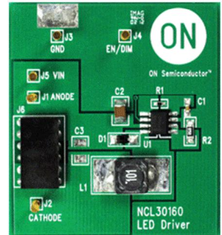
输入电压: 6.3V-40V; 输出电流: 700mA
