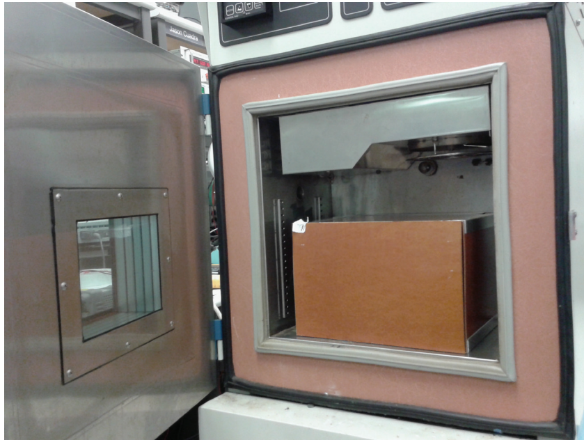
图9 - 用来防止气流通过被测电源的纸板箱所在的热处理室敞开式设置测量。
