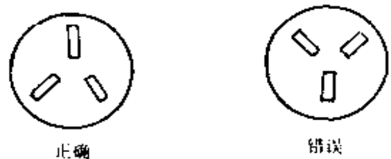
图4-22 三眼插座的安装
