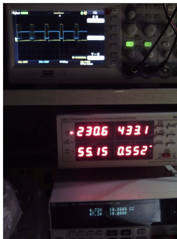
AC230V输入5V10A输出同步整流波形
