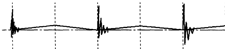
图 2 开关电源输出波形示意图
