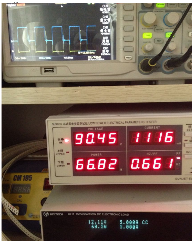
AC90V输入12V5A输出同步整流波形
