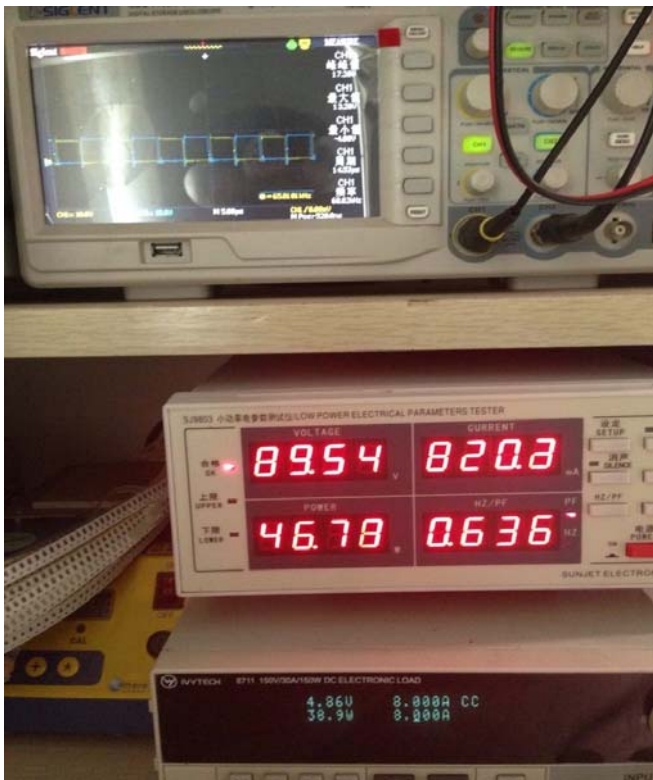
AC90V输入5V8A输出同步整流波形
