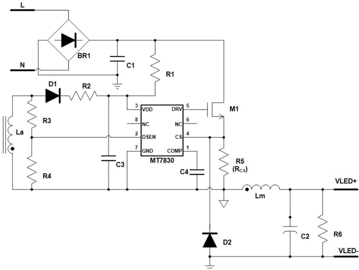
图.3 变压器辅助绕组为 VDD 管脚供电的应用电路
