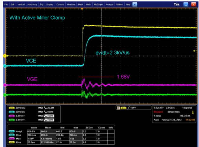
图8 - 使用米勒钳位技术VGE和VCE波形图
