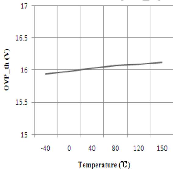
OVP 电压门限对温度的变化
