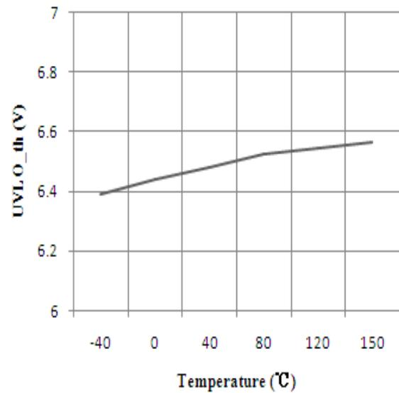
VCC 欠压保护门限对温度的变化
