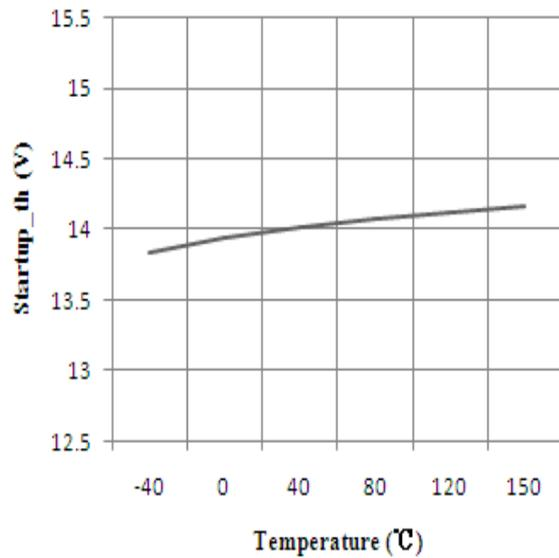
VCC 启动电压门限对温度的变化
