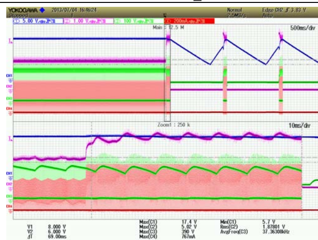
Vin=115Vac 输出短路，Vds_max=358V
