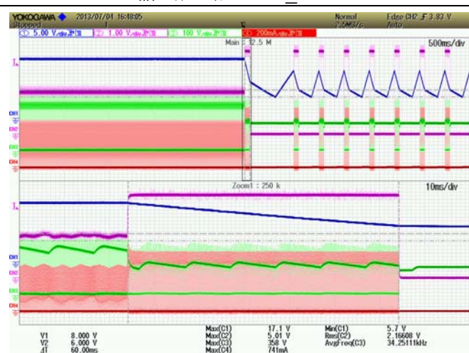
Vin=115Vac 输出短路，Vds_max=358V
