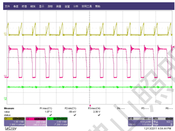
Fig.25 V_{cs} & V_{ds} & V_{comp} waveform @264Vac/50Hz, spread
