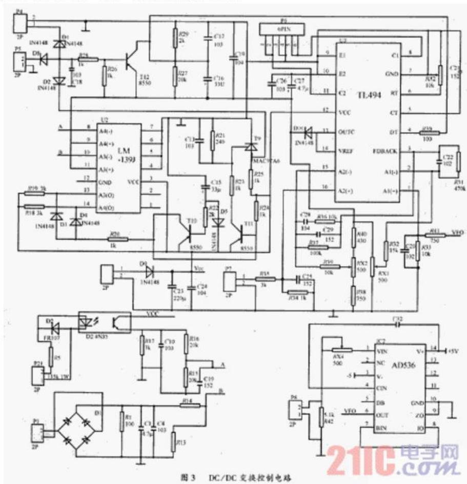
图 3 DC/DC 变换控制电路
