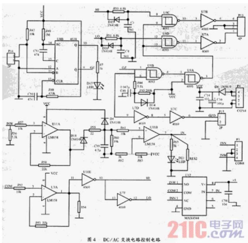
图 4 DC/AC 变换电路控制电路
