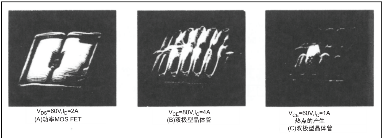
图28 外加功率时的芯片表面温度分布
