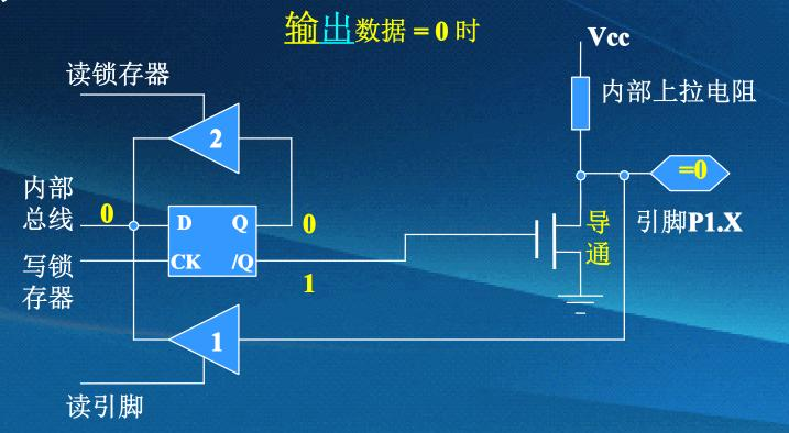
• P1.0—P1.7: 准双向I/0口(内置了上拉电阻)输出时一切照常,仅在作输入口用时要先对其写"1"。
