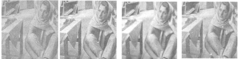
A 加入加性噪声后的图像 B 空域滤波 C 双树复小波阈值方法 D 双密度收缩函数算法
